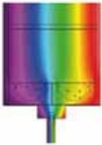
**La variation de la température d'un mur extérieur en briques non isolées, en contact avec une fenêtre.** Dans ce cas, les températures superficielles du mur interne sont beaucoup plus froides avec risque de condensation et formation de moisissures (hypothèse  $T_e = -5^\circ$  e  $T_i = 20^\circ\text{C}$  pour une température superficielle interne d'environ  $12-14^\circ$ . Il en résulte un Facteur Superficiel correspondant au Coefficient  $U$  ( $\text{W}/\text{m}^2\text{K}$ ) = 0.70-0.75).
